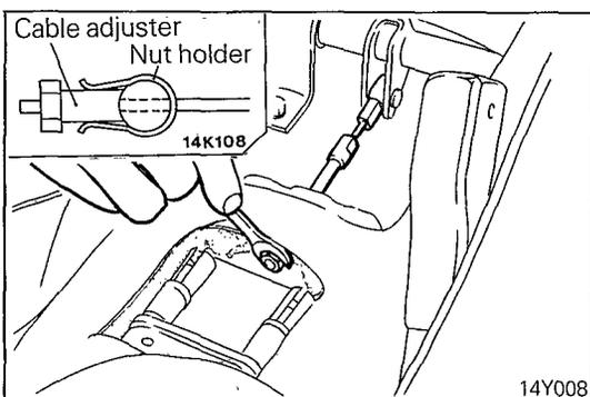
**PARKING BRAKE LEVER STROKE CHECK**
