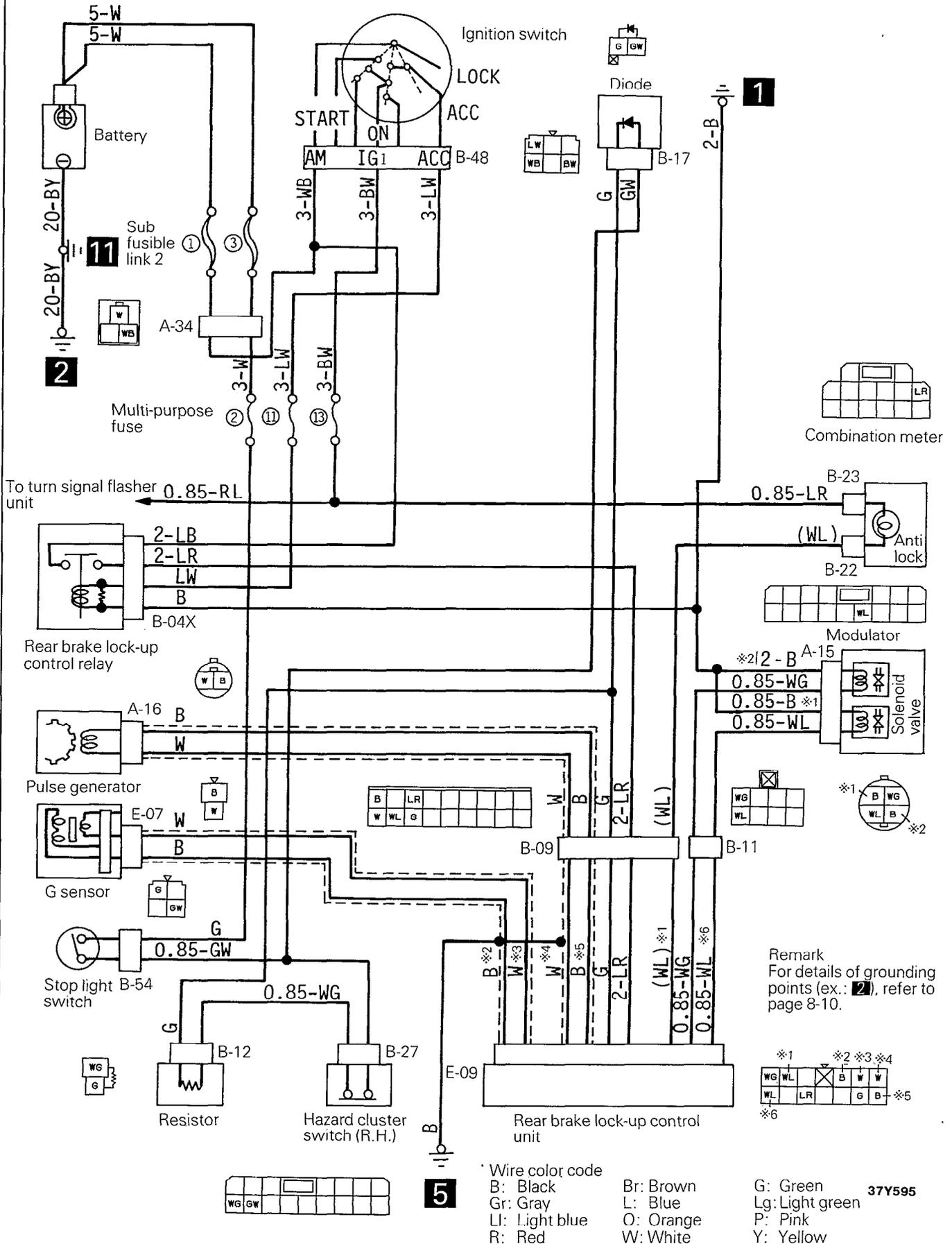
REAR BRAKE LOCK-UP CONTROL SYSTEM – CONTROL PARTS LAYOUT
