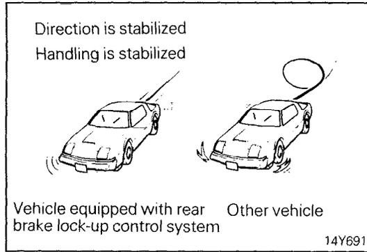
**REAR BRAKE LOCK-UP CONTROL SYSTEM**
