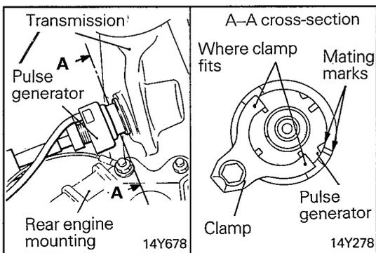
**2. INSTALLATION OF PULSE GENERATOR**
